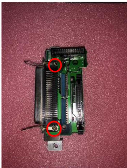
3. 拡張 HDD コネクタ基板(写真左側)を取り外し、さらに赤丸部分のネジを外します。
