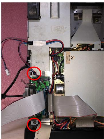
12. 付属品 No.7「電源分岐ケーブル」を取り付けます。
