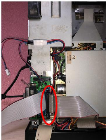
14. 既存の 68 本体のコントロール基板から伸びている内蔵 FDD ケーブルを取り外し、このコネクタは使用しないので、隙間に入れておきます。(写真左側の赤丸部分)
