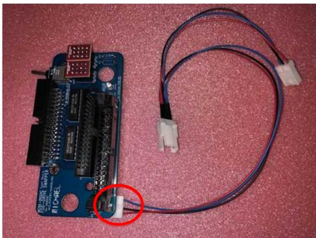
7. FDS 基板（裏面）の下図赤丸の部分に「スペーサー」が付いていることを確認して下さい。
