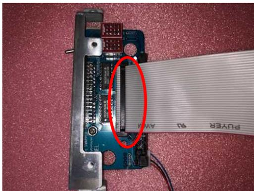
10. 拡張 HDD 基板をセットして、赤丸部分でネジ止めします。
