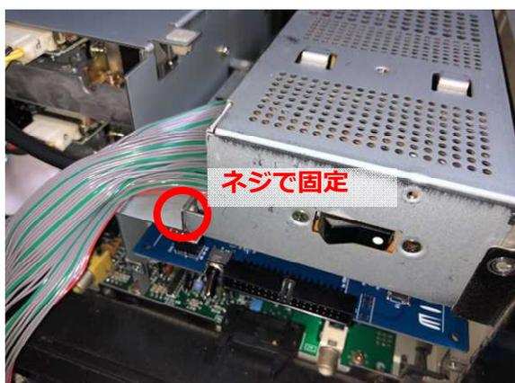
6. 付属品 No.2「FDS - 内蔵 FDD 間フラットケーブル」を、写真のように内蔵 FDD のカードエッジ部分に取り付けます。(写真 赤丸①)
