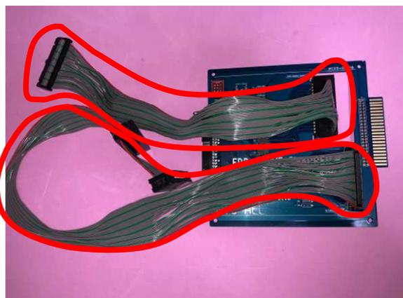
付属品のフラットケーブルの種類によっては、赤い線（Pin1）が無い場合、以下の方法でPin1 の場所を確認して下さい。
