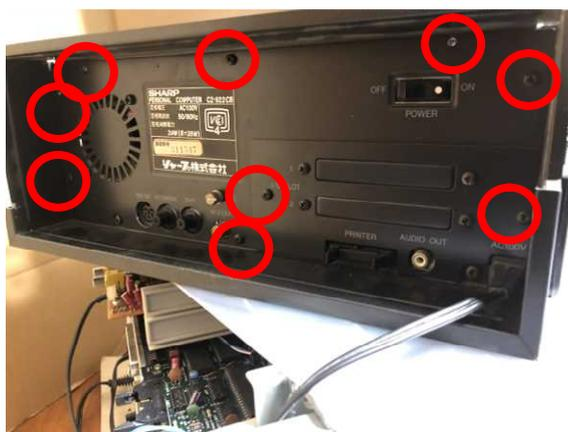
2. 取り付ける予定の I/O SLOT 1 or 2 のパネルも外します。
