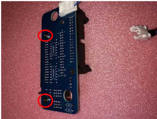
8. ステータスに FDS 基板をセットし、赤丸部分でネジ止めします。
