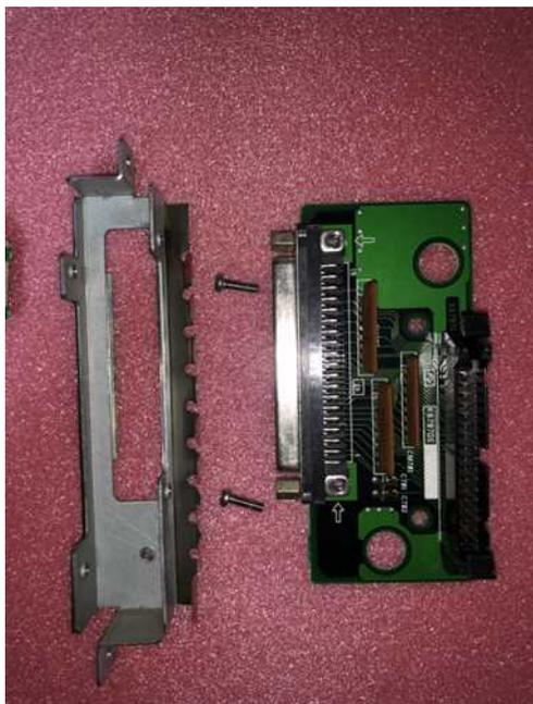
5. 下記の説明に従って、FDX68 や HxC などの接続する機器に応じた、ジャンパー設定用の基板 または ジャンパーピン/ケーブルを用意します。
