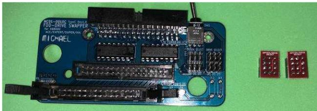
FDX68 接続用のジャンパー設定基板を取り付けます。(赤丸部分)
