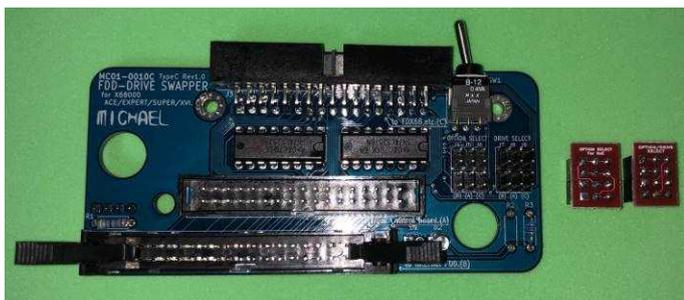
HxC 接続用のジャンパー設定基板を取り付けます。(赤丸部分)
