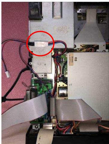
13. 内蔵 FDD から拡張 FDD コネクタ基板に伸びていた 34pin コネクタを FDS 基板の赤丸部分に取り付けます。(コネクタを押し込むと、ロックされたようになりますが、ロック部分に遊びがあるため、キッチリ奥まで差し込んで下さい。)
