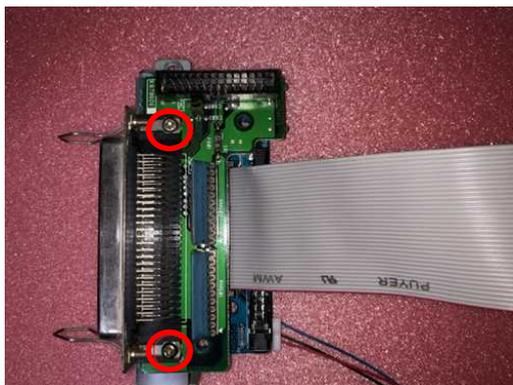
11. 拡張 HDD コネクタ、FDS 基板を、本体にネジ止め (赤丸) して下さい。
