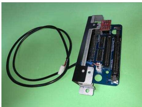
9. FDS 基板上の赤丸で示した 34pin コネクタ部分に**付属品 No.2「ControlBoard - FDS 基板間フラットケーブル」**を取り付けます。(ケーブルの方向に注意して、キッチリ奥まで差し込んで下さい。**ストreinリリース (バー型のパーツ) が付いている方を、FDS 基板に差し込んで下さい**)
