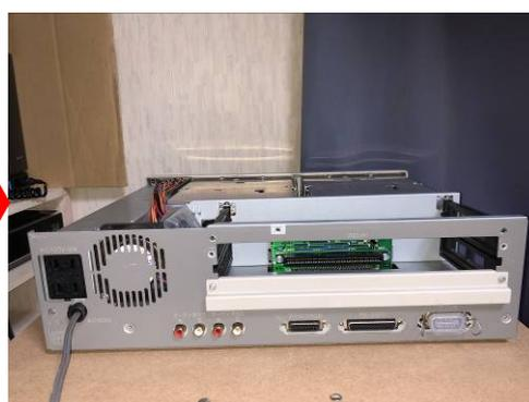
3. フロッピーディスクドライブ（以降、FDD と呼ぶ）に接続されているケーブルにアクセスするため、写真の緑枠で囲んだ部品「ライザーカードやガイドレールが固定されている板金ごと」を、本体から外します。
