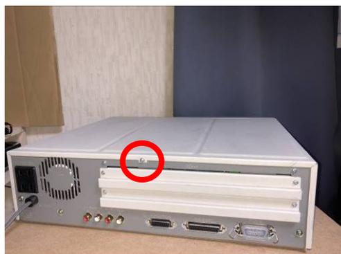
2. 後部パネルと、取り付ける予定の 拡張スロット 1 or 2 のパネルも外します。
