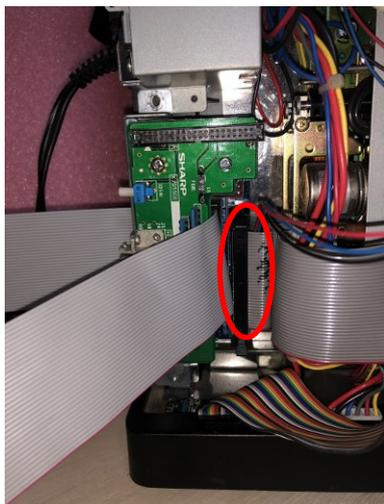
14. 既存の 68 本体のコントロール基板から伸びている内蔵 FDD ケーブルを取り外し、隙間に入れておきます。（写真左側の赤丸部分）
