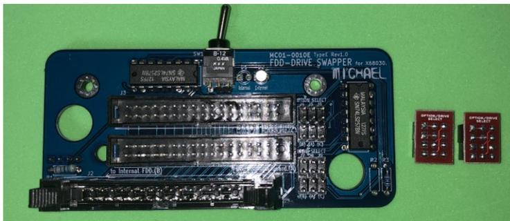
FDX68 接続用のジャンパー設定基板を取り付けます。(赤丸部分)
