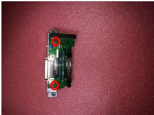
3. 拡張 HDD コネクタ基板(写真左側)を取り外し、さらに赤丸部分のネジを外します。
