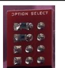
220Ω<br>青色   | チップ抵抗を搭載しています。<br>FDX68 接続時の OPTION SELECT に使用します。                   |
